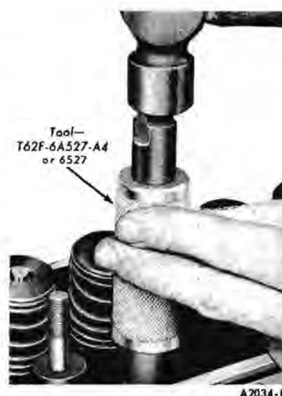
FIG. 21—Rocker Arm Stud Installation
