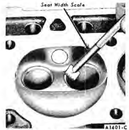
FIG. 25—Valve Seat Width
