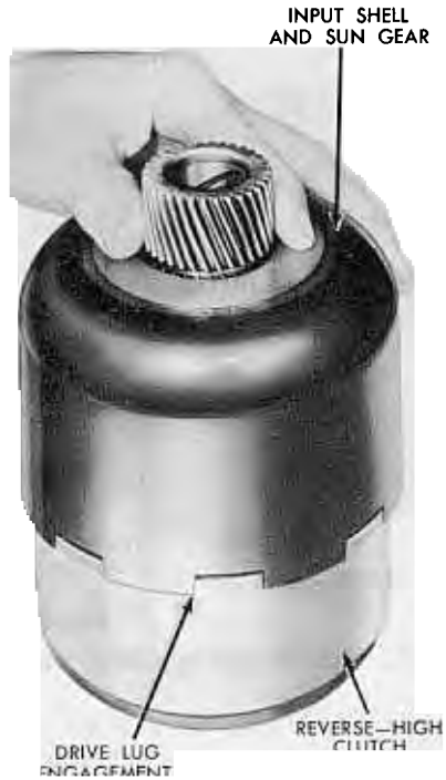
FIG. 101—Installing Input Shell
