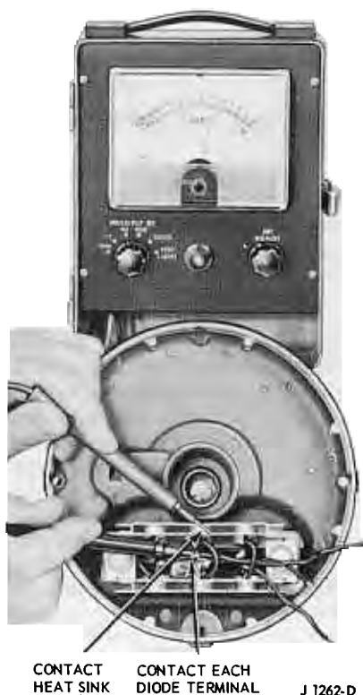
FIG. 11—53-Ampere Leece Neville Diode Test
