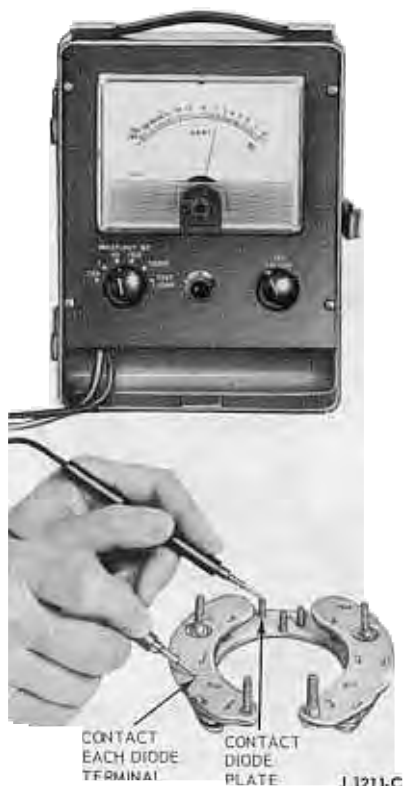
FIG. 10—Autolite Diode Test
